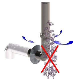
Abb. 10 Verbrennungsluft-Ansaugung frei halten
