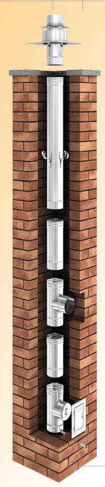
Einwandige und doppelwandige Systeme mit konventioneller Steckverbindung (Stutzen/Muffe):
